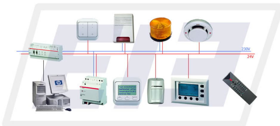
Obr. 10.24 Sestava systému ABB i-bus
